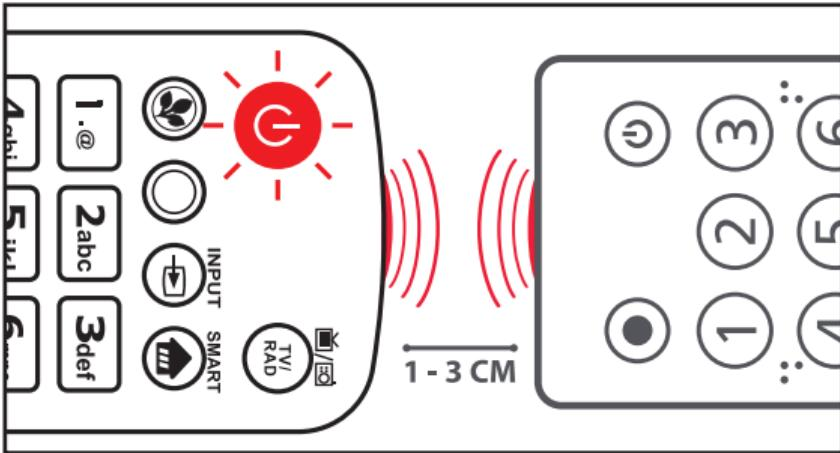
4. По завершении программирования зажмите кнопку OK в течение 3 секунд. Световой индикатор погаснет, функции кнопок сохранятся, а пульт выйдет из режима программирования.
