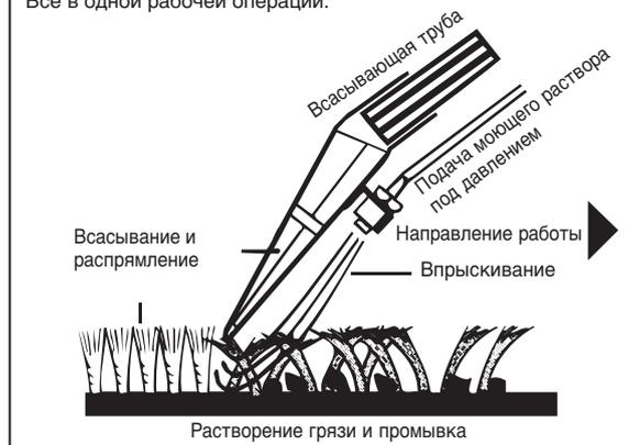
Нажать рычаг запорного клапана (24) до выхода моющей жидкости, а приложенную к коврам насадку провести прямой полосой по коврам. В конце полосы или при перерыве отпустить рычаг клапана, чтобы остановить струйное распыление. После того как распыленная жидкость собрана, приподнять насадку и начать новую полосу с небольшим наложением на предыдущую. Так полосу за полосой можно обработать всю поверхность.
