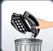
**RU** После каждого использования следует очищать контейнер для мусора. Для этого следует нажать кнопку на задней стороне робота и извлечь контейнер, после откинуть крышку, чтобы очистить его.
