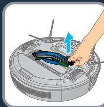
**RU** Очищайте щетку робота раз в неделю. Чтобы извлечь щетку, переверните робот, откройте защелки и выньте крышку щетки.
