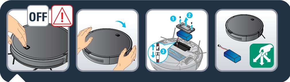
**RU** Внимание! Выключите робот перед извлечением аккумулятора. Для доступа к отсеку аккумулятора, переверните робот, нажмите на защелки отсека и извлеките аккумулятор.
