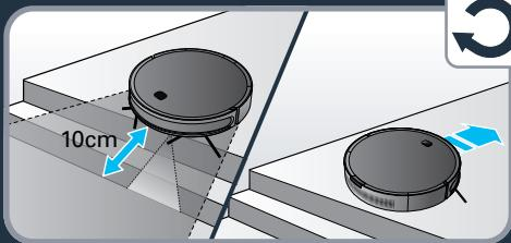
**RU** Робот оснащен датчиками падения для распознавания лестниц и обрывов. Чтобы робот правильно распознавал неровности уровня пола, убедитесь, что на полу рядом с лестницами, ступенями или обрывами отсутствуют какие-либо предметы (сумки, обувь и т. д.). Лестницы, ступени и обрывы корректно распознаются датчиками на расстоянии не менее 10 см.
