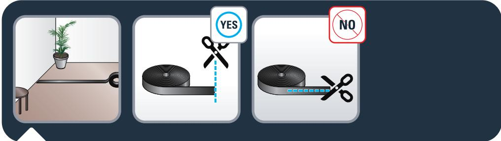
**RU** Используйте магнитную ленту для ограничения доступа робота в определенные зоны.
