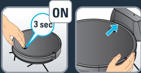
**RU** Чтобы зарядить робот, нажмите и удерживайте кнопку включения в течение 3 секунд. Поместите робот на зарядную станцию так, чтобы его контактные пластины касались клемм на зарядной станции.
