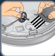
**RU** Регулярно очищайте специальной щеткой переднее, левое и правое колеса. На вал колеса могут накручиваться волосы, полоски ткани и т. д., поэтому его следует своевременно очищать.
