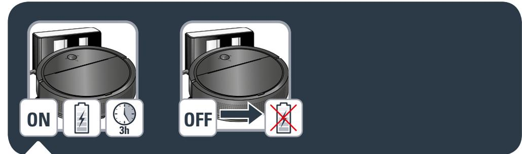
**RU** ON («ВКЛ.») (I): робот-пылесос заряжается (3 часа до полной зарядки аккумулятора). OFF («ВЫКЛ.») (O): робот-пылесос не заряжается.
