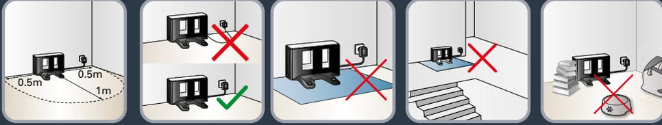
**RU** Разместите зарядную станцию таким образом, чтобы с каждой стороны от нее оставалось по 0,5 м свободного пространства, а перед ней – 1 м. Не ставьте зарядную станцию рядом с лестницей. Кабель должен быть натянут. Размещайте зарядную станцию на твердой поверхности. Не размещайте зарядную станцию на коврах.
