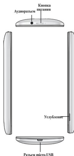
**ПРИМЕЧАНИЕ:** Для открытия задней крышки, подденьте ее за углубление на боковой поверхности.
