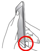
2. Приподнимите крышку и снимите ее.
