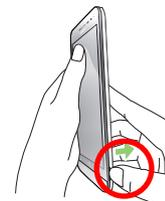
2. Приподнимите крышку и снимите ее.
