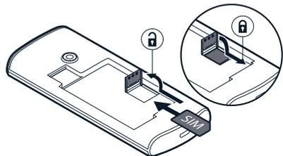
4. Если у вас телефон с двумя SIM-картами, сдвиньте держатель SIM-карты в гнезде SIM2 влево и откройте его, подняв вверх. Вставьте nano-SIM-карту в разъем SIM2 контактами вниз, опустите держатель и сдвиньте его вправо до фиксации.
