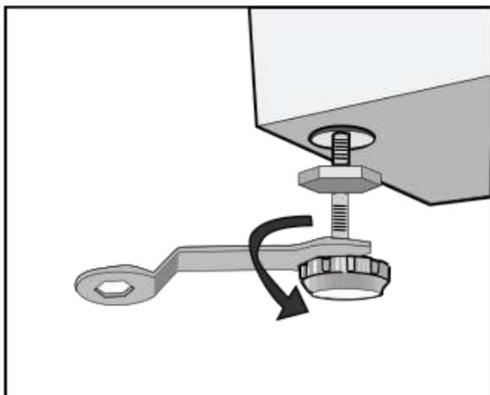
Обеспечьте ровное и устойчивое положение стиральной машины. Ослабьте стопорную гайку гаечным ключом и поворачивайте ножку вручную до полного контакта с полом. Прижмите ножку одной рукой, а другой затяните гайку.
