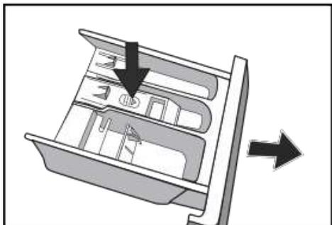
1. Нажмите в направлении стрелки, расположенной на отсеке для кондиционера внутри выдвижного лотка.
