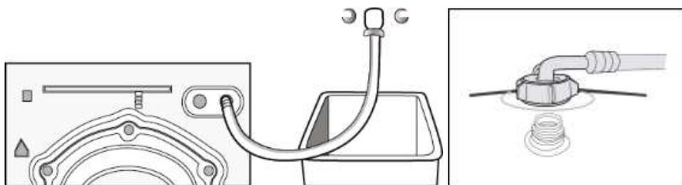
**Примечание:** после соединения, если наблюдается течь шланга, повторите предыдущие действия по подсоединению наливного шланга.
