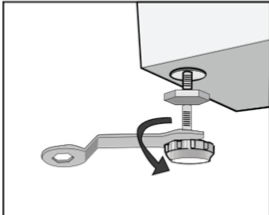
Обеспечьте ровное и устойчивое положение стиральной машины. Ослабьте стопорную гайку гаечным ключом и поворачивайте ножку вручную до полного контакта с полом. Прижмите ножку одной рукой, а другой затяните гайку.
