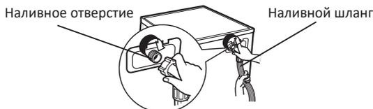
Примечание: после соединения, если наблюдается течь шланга, повторите предыдущие действия по подсоединению наливного шланга.
