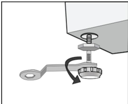
Обеспечьте ровное и устойчивое положение стиральной машины. Ослабьте стопорную гайку гаечным ключом и поворачивайте ножку вручную до полного контакта с полом. Прижмите ножку одной рукой, а другой затяните гайку. После этих действий еще раз нажмите на корпус машины по четырем углам последовательно, чтобы убедиться, что она правильно выровнена. Если это все еще не так, повторите действия, описанные выше.
