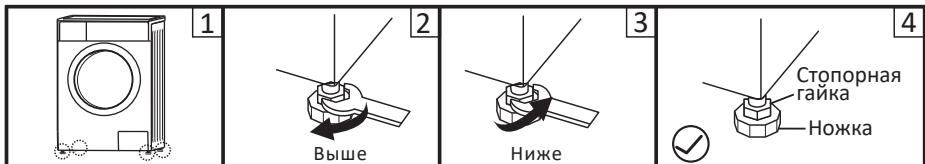
1. Ослабьте стопорную гайку гаечным ключом и поворачивайте ножку вручную до полного контакта с полом. Прижмите ножку одной рукой, а другой затяните гайку.
