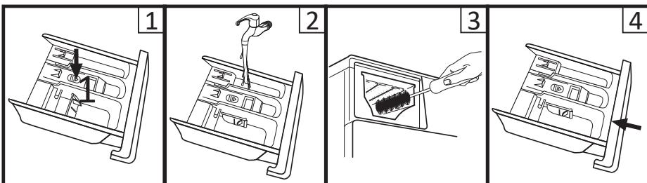
1. Выньте лоток, нажав на область, обозначенного цифрой 1.
