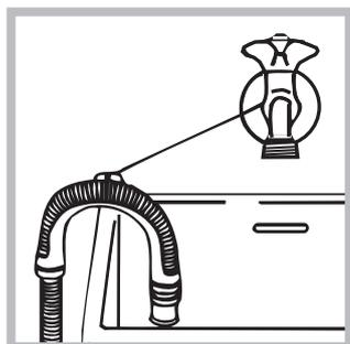
Или поместите шланг в раковину или в ванну, закрепив прилегающую направляющую к крану (см. схему). Свободный конец сливного шланга не должен быть погружен в воду.
