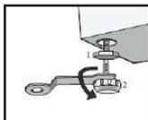
После того как прибор будет установлен в место предполагаемого использования, отрегулируйте его по уровню с помощью инструмента, затем зафиксируйте положение ножек с помощью контргайки. Стиральную машину следует устанавливать на твердой и ровной поверхности.
