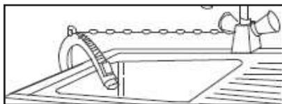
Если в качестве слива используется раковина, гофрированный сливной шланг должен быть расположен над отверстием перелива для предотвращения скопления воды. Для более надежного крепления на борту раковины используйте изогнутый держатель.
