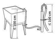
Если сливной шланг слишком длинный, не вталкивайте его в устройство. Это может привести к повышенному шуму. • При соединении с раковиной сливной шланг нужно надежно закрепить на цепочке.
