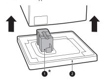
Убедитесь, что опора барабана ①\* отсоединилась вместе с подложкой, а не застряла в нижней части устройства.  Если потребуется положить устройство, чтобы снять картонную подложку ②, обязательно обеспечьте защиту соответствующей боковой стенки и аккуратно положите устройство на бок. Укладывать устройство на переднюю или заднюю поверхность запрещено.
