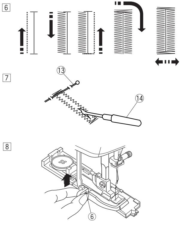
6 Петля будет создана в последовательности, указанной на рисунке. По завершении выполнения петли машина остановится автоматически с иглой в верхнем положении.
