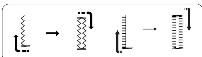
Машина сначала прошьёт переднюю закрепку и левую сторону петли, затем заднюю закрепку и правую сторону петли. При завершении остановится автоматически.
