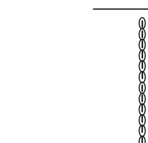
Этот крепкий и прочный стежок рекомендуется для тех областей, где необходима как эластичность, так и прочность. Его используют в областях проймы и шаговых швов, а также на рюкзаках для придания дополнительной прочности.
