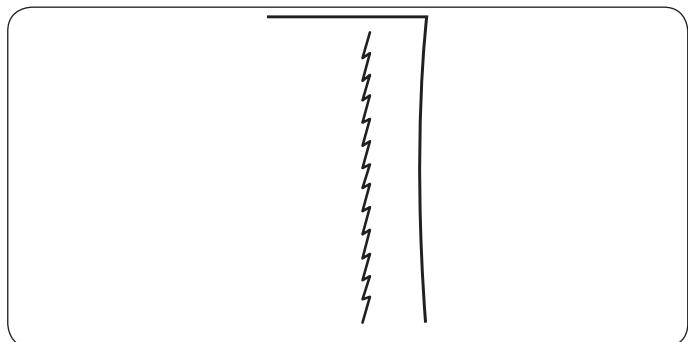
Этот узкий шов разработан для устранения складок на трикотажных тканях и при пришивании косой бейки, чтобы шов можно было полностью раскрыть и сделать плоским.
