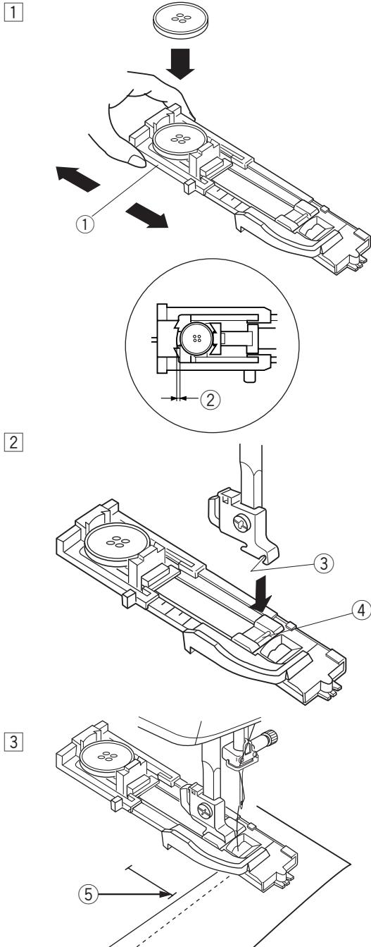
Размер петли автоматически определяется по размеру пуговицы, помещенной в лапку для автоматической петли R.
