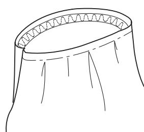
Отметьте соответствующие части ткани и резинки. Сопоставьте отметки на резинке и ткани и подколите резинку к ткани.
