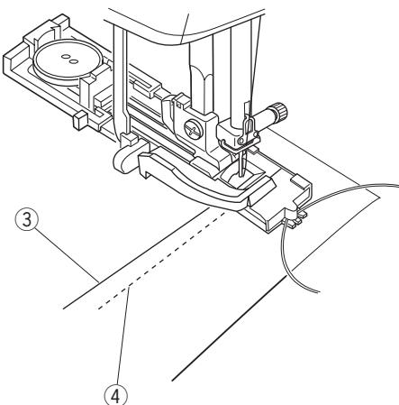
2 Запустите машину и прошейте петлю. Каждая сторона петли и поперечины будут созданы поверх шнура. Снимите ткань с машины и обрежьте только нитки.
