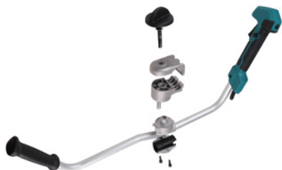
Схема крепления рукоятки
