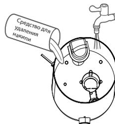
Для очистки резервуара изнутри залейте в него немного кипячёной воды с небольшим количеством средства для удаления накипи, вымойте и протрите насухо.
