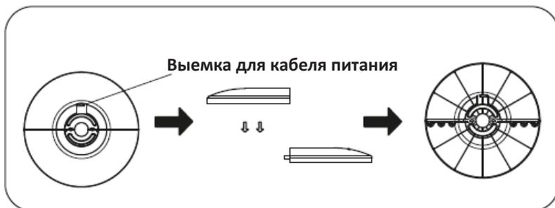
2. Протяните шнур питания через выемку, а затем установите корпус на основание.
