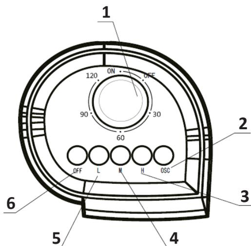
1. Поворотный переключатель вентилятора и таймера (по окончании выбранного времени вентилятор выключается).
