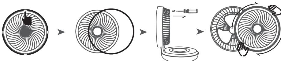
Тщательно очистите заднюю решетку, лопасти, переднюю решетку и обод. Соберите все части вентилятора в обратной последовательности. Обод нужно установить защелками в пазы на передней решетке до щелчка.
