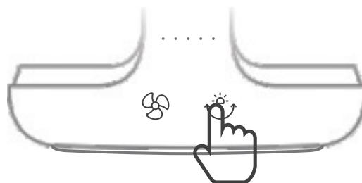
При удержании кнопки подсветки/вращения в течение 3 секунд загорится световое кольцо на основании устройства теплым мягким светом. Повторное удержание кнопки отключает подсветку. Подсветку можно включать и при выключенном устройстве, и при работающем устройстве, и при вращении устройства.
