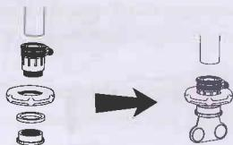
3.2. Подберите необходимый диаметр для излива. Внутри универсального штуцера находится две резиновые прокладки. Удалите маленькую прокладку при необходимости. Раскрутите хомут отверткой. Установите универсальный штуцер на излив. Плотно, но аккуратно закрутите хомут отверткой.
