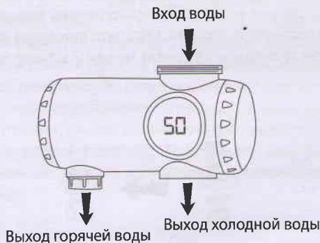
1. Убедитесь, что при пользовании водонагревателем протечек воды не наблюдается. Для этого, поверните ручку водонагревателя вверх на несколько секунд и вниз. Внимательно осмотрите корпус водонагревателя, соединение излива и место подключения воды на предмет протечек. Если протечки наблюдаются, устранийте их, прежде чем подключить электронагреватель к сети.
