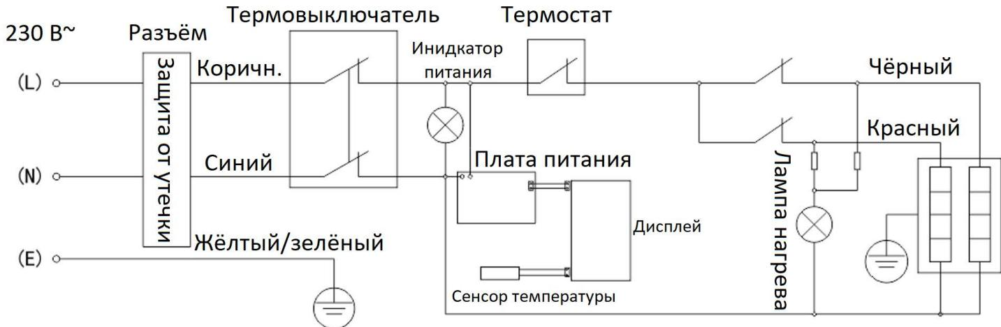
**Примечание:** для подключения электропитания к бойлеру рекомендуется провести от распределительного щита квартиры отдельный кабель сечением медной жилы не менее 2,5 мм, а сам распределительный щит обязательно оснастить прибором УЗО для защиты от поражения электрическим током в случае утечки электричества на корпус бойлера.
