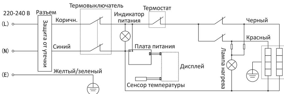
**Примечание:** для подключения электропитания к бойлеру рекомендуется провести от распределительного щита квартиры отдельный кабель сечением медной
