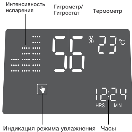
Рис. 4b Стандартный дисплей для режимов увлажнения
