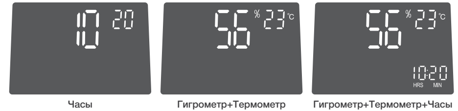
Рис. 5 Дисплей прибора в режиме Метеостанции
