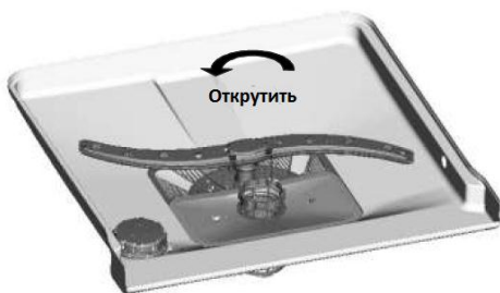
Шаг 1: Поверните фильтр против часовой стрелки.
