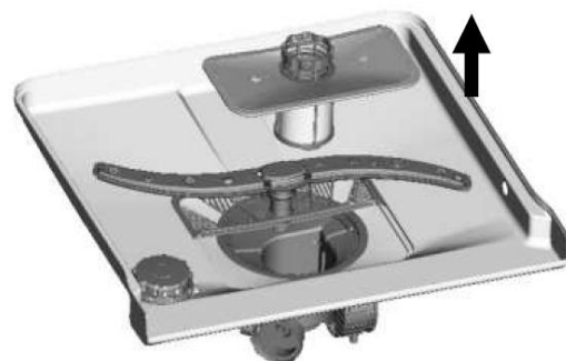
Шаг 2: Выньте фильтр движением вверх
