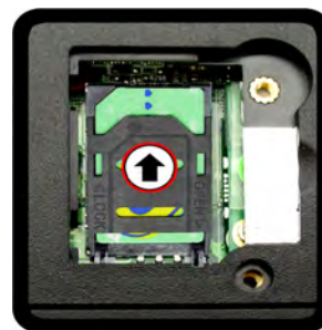
Abb. 7 Schließen des SIMLOCK-Riegels angeschlossenem AC/ DC-Adapter
