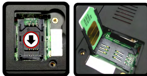
Abb. 6 - Lösen des SIMLOCK-Riegels
