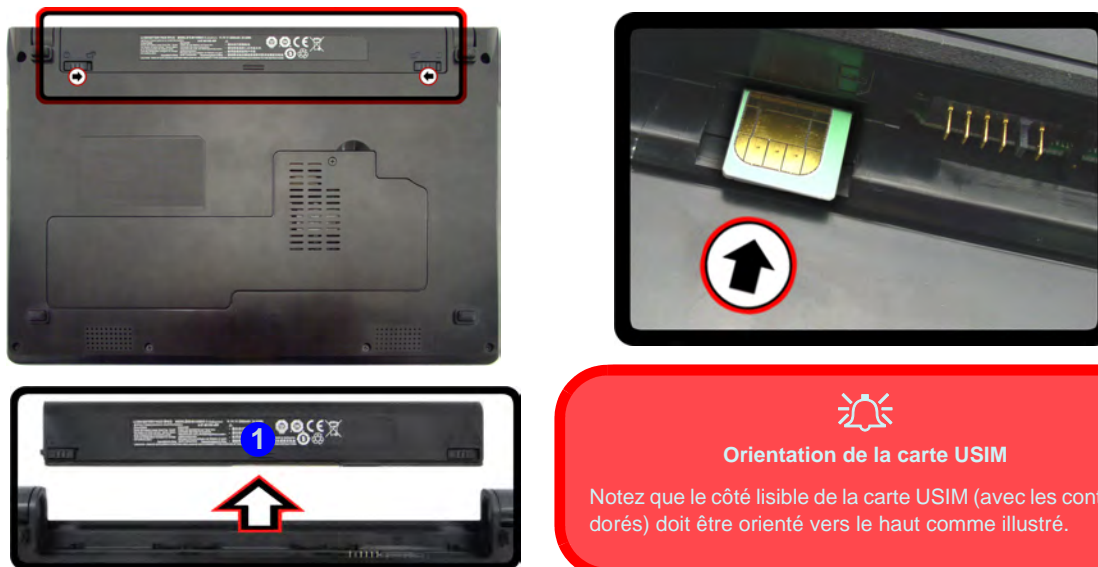
Figure 6 - Retirer la batterie et insérer la carte USIM
