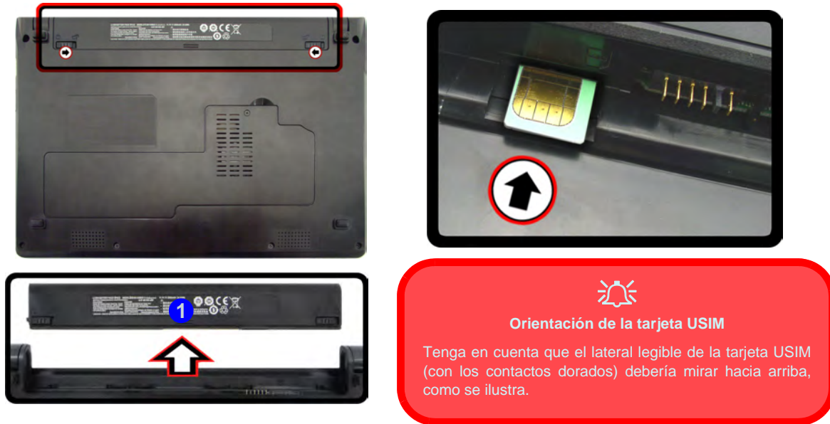
Figura 6 - Quitar la batería e insertar la tarjeta USIM
