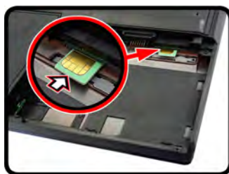
Figure 20 - Rimozione della batteria & Inserimento della carta USIM
