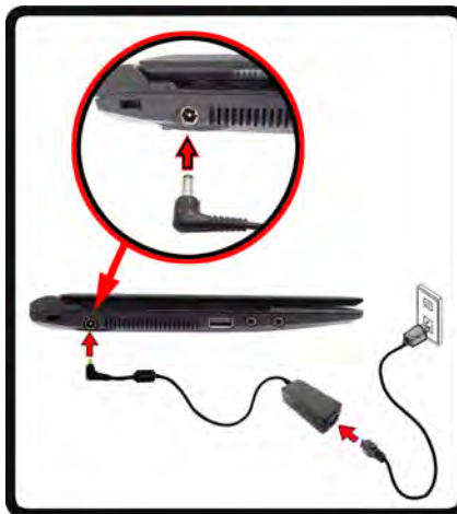
Figura 1 Abrir la tapa/LCD/ordenador con el adaptador AC/DC enchufado
