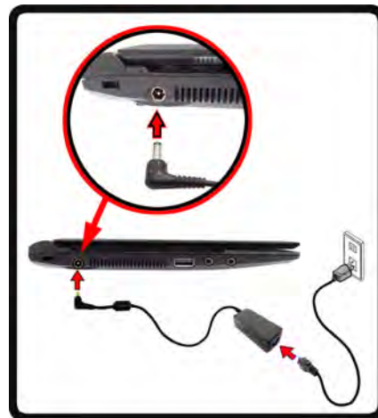
Figure 1 Ouvrir le couvercle/LCD/ordinateur avec un adaptateur AC/DC branché
