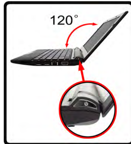
Abb. 1 Öffnen des Deckels/LCD/Computers mit angeschlossenem AC/DC-Adapter
