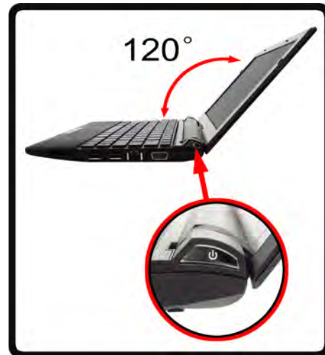
Figura 1 Apertura del coperchio/LCD/Computer con alimentatore AC/DC collegato
