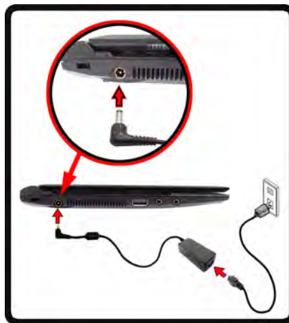
Figura 1 Apertura del coperchio/LCD/Computer con alimentatore AC/DC collegato
