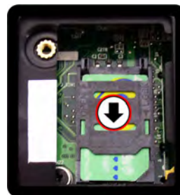
Figura 10 - Blocco del fermo della SIM
