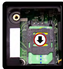
Figure 10 - Verrouiller le SIMLOCK
