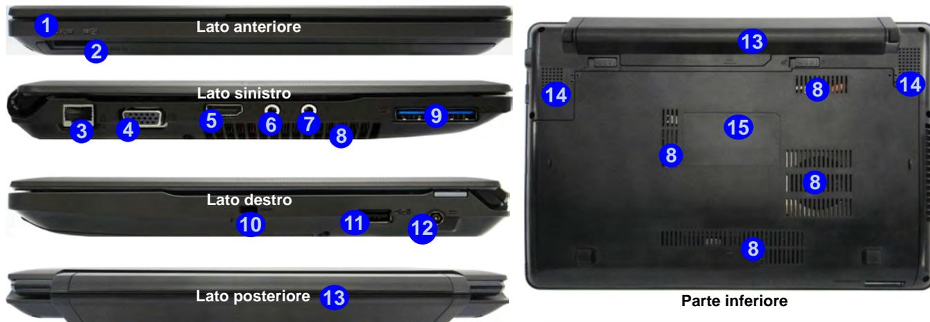
Figura 5 - Vista anteriore, sinistra, destra, posteriore e inferiore
