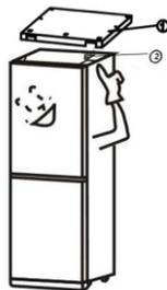
2. Поднимите дверь холодильной камеры вверх, чтобы отсоединить ее от средней дверной петли. Осторожно положите дверь на мягкую поверхность.
