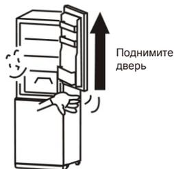
3. Используя отвертку, снимите среднюю дверную петлю. Поднимите дверь морозильной камеры вверх, чтобы отсоединить ее от нижней дверной петли. Осторожно положите дверь на мягкую поверхность.
