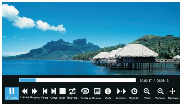
Нажмите кнопку INFO/ENTER на пульте ДУ для отображения панели управления на экране.
