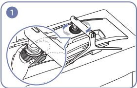
Поверните ВЕРХНЮЮ ЗАДНЮЮ КРЫШКУ против часовой стрелки.
