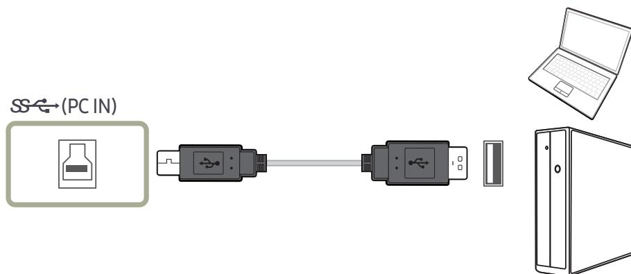
Подключите кабель USB к разъему на задней стороне изделия и порту USB компьютера.
