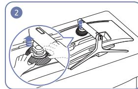
Приподнимите ВЕРХНЮЮ ЗАДНЮЮ КРЫШКУ.
