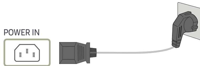
Для работы с устройством подключите кабель питания к электрической розетке и порту POWER IN на устройстве.
