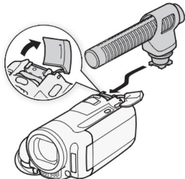
Пример. Установка дополнительно приобретаемого направленного стереомикрофона DM-100.
