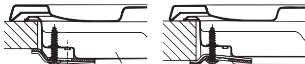
Position der Haken für Arbeitsplatten H=20mm
