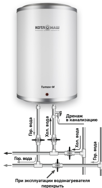
Рисунок 2. Схема подключения к водопроводу.
