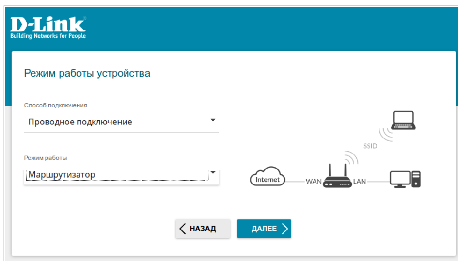
Рисунок 26. Выбор режима работы устройства. Режим Маршрутизатор .
