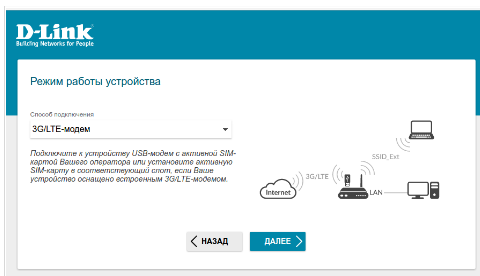
Рисунок 27. Выбор режима работы устройства. Режим 3G/LTE-модем .
