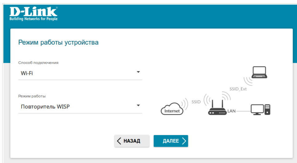
Рисунок 28. Выбор режима работы устройства. Режим Повторитель WISP .
