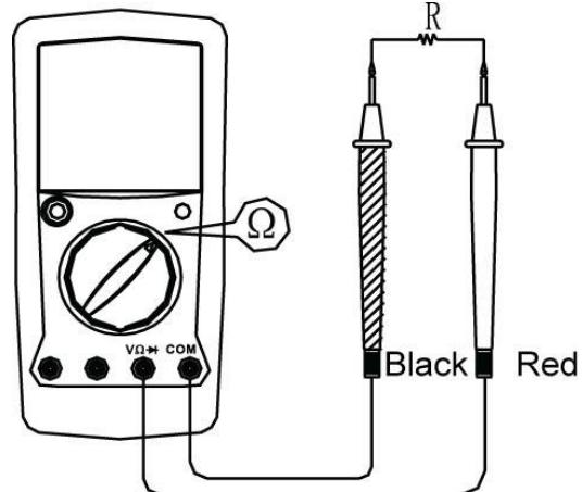
Если значение сопротивления закороченных щупов более 0.5 Ом, проверьте исправность щупов и правильность выбора измерительной функции.
