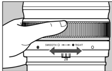
Вы можете настроить нужное “усилие”, требуемое для настройки масштабирования, (сила сопротивления на трансфокаторе), поворачивая кольцо регулировки и удерживая при этом кольцо фокусировки на месте.
