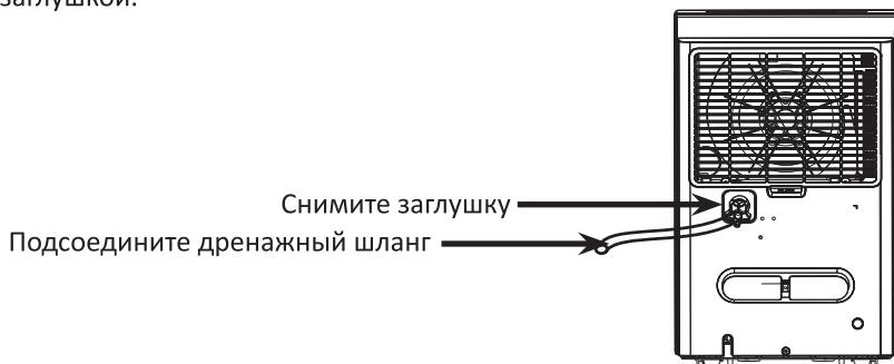
Примечание. Чтобы обеспечить надлежащую работу, не перетягивайте и не сгибайте шланг. Убедитесь, что вокруг воздуховыпускного отверстия вытяжного шланга (в радиусе 50 см) нет препятствий, которые могут блокировать выходящий поток воздуха, нарушая тем самым работу устройства.
