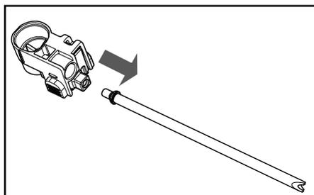
**6** Снимите штуцер с трубки.
