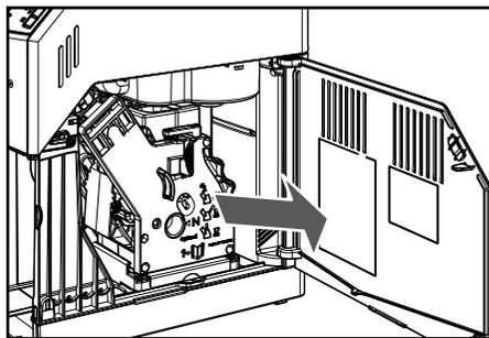
**4** Достаньте блок приготовления кофе, для этого потяните за специальную ручку и нажмите кнопку «PUSH». Блок приготовления кофе можно мыть только теплой водой без моющего средства.
