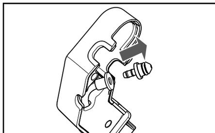
**5** Снимите трубку со штуцером.
