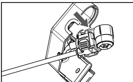
**3** Снимите нижнюю часть корпуса.
