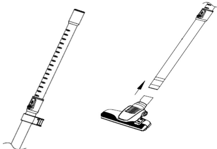
Підготовка насадки для чищення килимів, плиток, дерев'яних покриттів:
