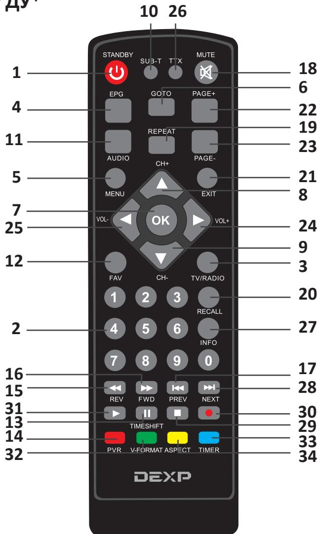
1. STANDBY: включение/выключение устройства.
