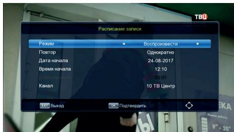
Используйте кнопки ▲/▼, чтобы настроить параметры таймера. Вы также можете удалить созданный таймер. Нажмите зелёную кнопку, чтобы редактировать уже созданный таймер, или синюю, чтобы удалить его.
