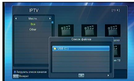
Для добавления плейлиста в формате XML необходимо скопировать его на USB-накопитель, затем, находясь в меню «Cloud», нажать зеленую кнопку на пульте ДУ и дождаться загрузки списка телеканалов. При необходимости нажать синюю кнопку на пульте ДУ, чтобы в ручном режиме обновить список каналов из загруженного вами плейлиста.
