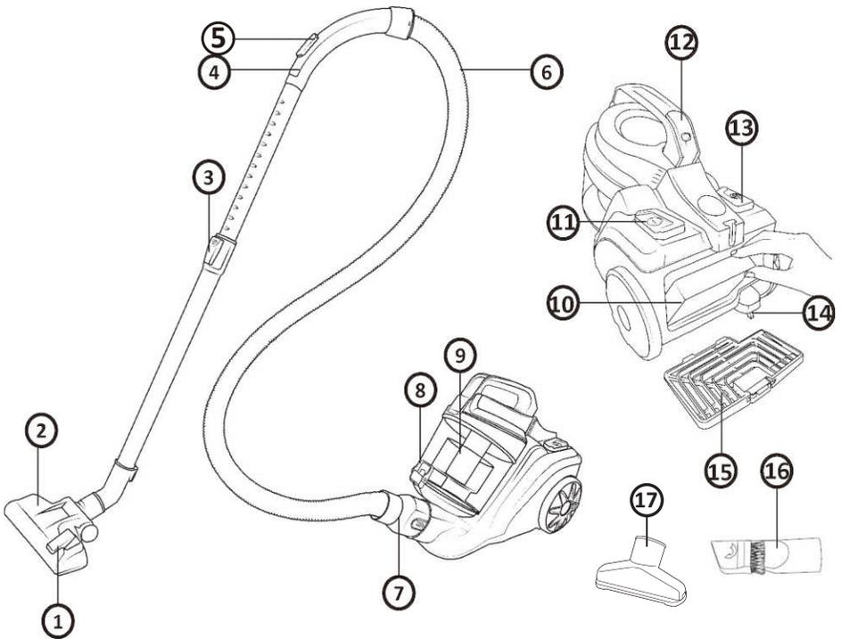
1. Переключатель для регулятора положения щетки для ковра и пола
