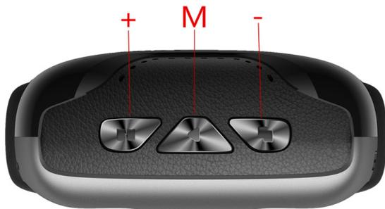
Нажмите кнопку «М», войдите в режим меню. С помощью кнопок «+» или «-» выберите значение, нажмите «М» для перехода к следующему параметру. В случае бездействия в течение 3 секунд устройство выйдет из меню. Нажмите и удерживайте кнопку «М» в течение 3 секунд для выхода из меню.
