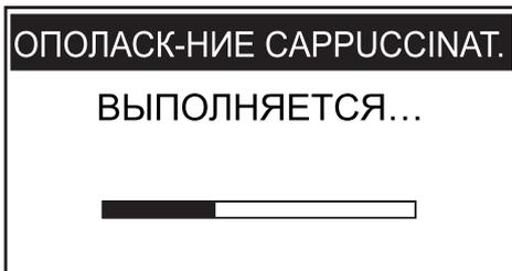
Машина произведет цикл ополаскивания Carpuccinatore. Полоска шкального индикатора показывает прогресс ополаскивания.
