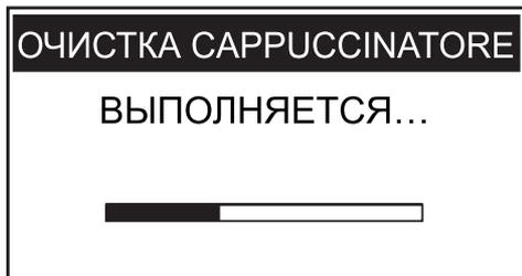
Полоска шкального индикатора показывает прогресс промывки. Дождитесь автоматического завершения цикла. По окончании цикла на дисплее появится:
