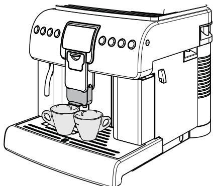
Сдвиньте устройство подачи до упора, чтобы можно было использовать высокие стаканы или кружки. В этом случае за раз возможна подача только одного напитка.
