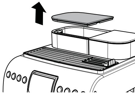
Достаньте бак; поднимите его при помощи специальной ручки, установленной внутри.
