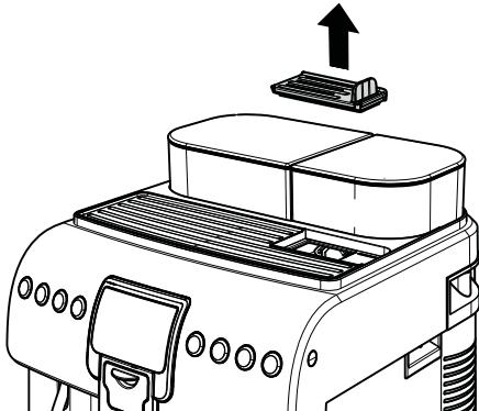
Насыпьте 1 мерку предварительно намолотого кофе в отделение; для этой операции пользуйтесь только меркой из комплекта поставки машины. Затем закройте крышку.
