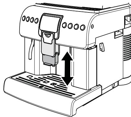
Для выполнения регулировки приподнимите или опустите вручную устройство подачи.
