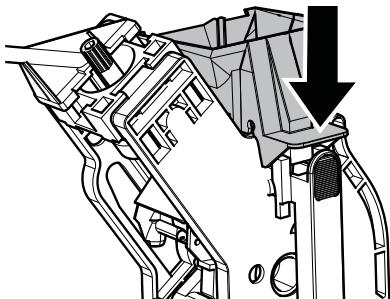
Установите заново блок приготовления кофе в специальное отделение до достижения соединения BEZ нажатия на кнопку «PRESS».
