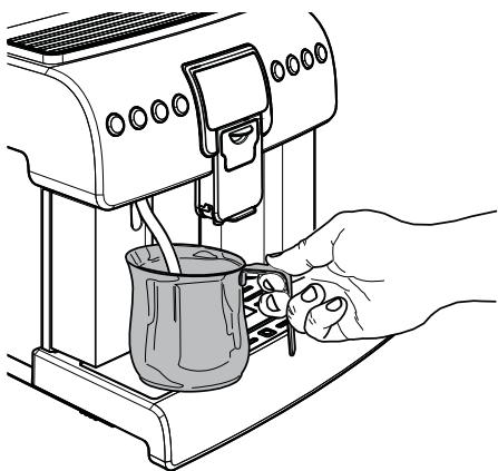
Нажмите кнопку «Специальные напитки» и кнопку «Кофе», чтобы выбрать и включить подачу ГОРЯЧЕЙ ВОДЫ. По окончании подачи горячей воды опорожните емкость.
