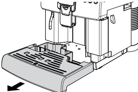
Вылейте жидкость из поддона для сбора капель и помойте его. Установите на место поддон для сбора капель.
