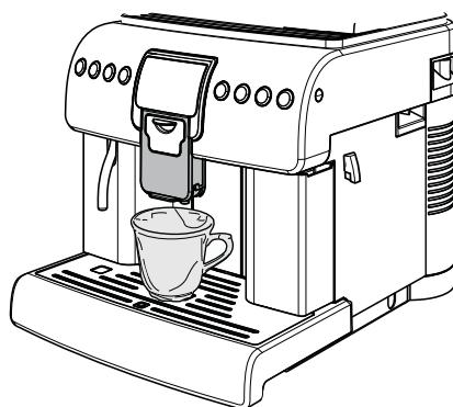
Выберите функцию подачи предварительно намолотого кофе, нажав один раз кнопку «Предварительно намолотый кофе». На дисплее отобразится, что была выбрана функция предварительно намолотого кофе. Нажмите кнопку «Кофе» для выбора кофе.
