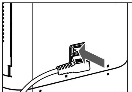
**2** Включите машину с помощью главного выключателя и...
