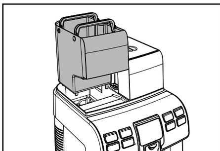
**4** Ополосните его и наполните свежей водой; не превышайте максимальный уровень (MAX), указанный на баке.
