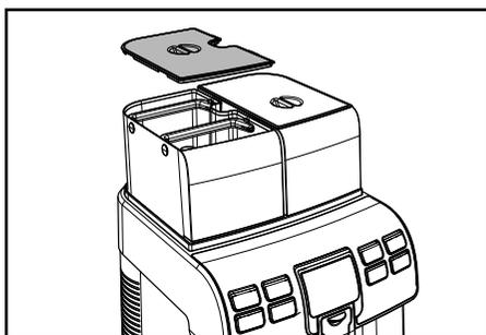
**3** Достаньте бак; поднимите его при помощи специальных ручек, установленных внутри.
