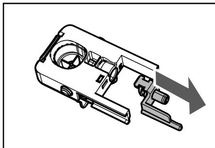
**13** Снимите соединение всасывающей трубки с Cappuccinatore.
