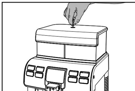
**2** После разблокирования поднимите и снимите крышку.
