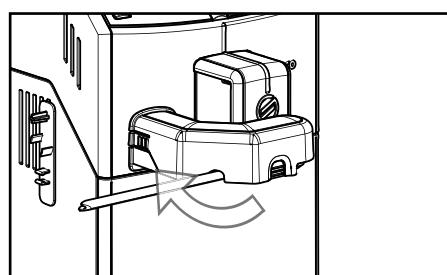
**i** Примечание: в периоды, когда насадка Cappuccinatore не используется, всасывающую трубку следует поместить в держатель, расположенный слевой стороны машины.
