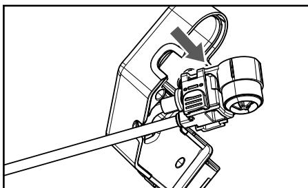
**3** Снимите нижнюю часть корпуса.
