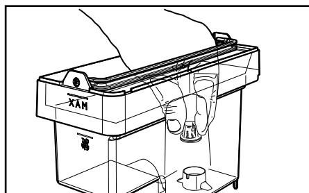
**⚠ Противоизвестковый фильтр необходимо заменять в случае подачи машиной соответствующего сигнала. Перед проведением цикла удаления накипи необходимо извлечь противоизвестковый фильтр из бака для воды.**
