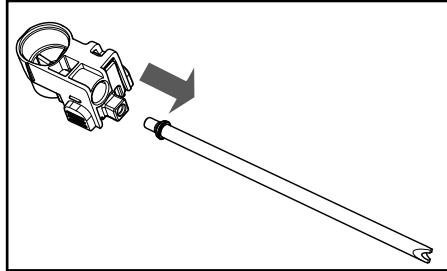
**6** Снимите штуцер с трубы.
