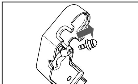
**5** Снимите трубку со штуцером.
