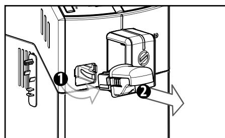
**2** Слегка наклоните насадку Cappuccinatore. Полностью вставьте ее в направляющие машины.
