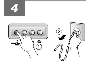
Выньте щётку і виключіть апарат, нажав кнопку "0". Виключіть апарат із сіті. Выньте центрифугу і прополоскайте її. Очистіть щётку.
