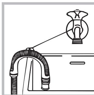
или поместите шланг в раковину или в ванну, закрепив прилагающуюся направляющую к крану (см. схему). Свободный конец сливного шланга не должен быть погружен в воду.
