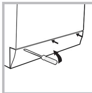
1. снимите переднюю панель стиральной машины при помощи отвертки (см. схему);
